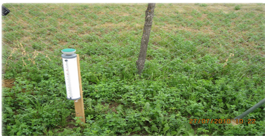
Fig.3. Atmometri që imiton bimën e jonxhës dhe mat ET_p , i instaluar në të dy vendndodhjet eksperimentale
