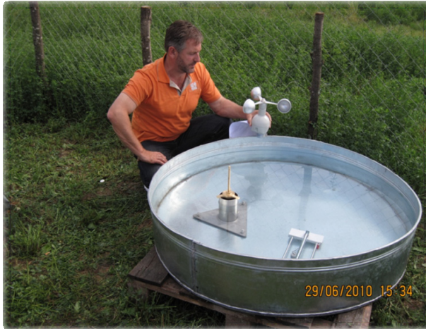
Fig.4. Evaporimetri Pan A që mat avullimin e ujit nga një sipërfaqe e lirë ujore, i instaluar në të dy vendndodhjet eksperimentale
