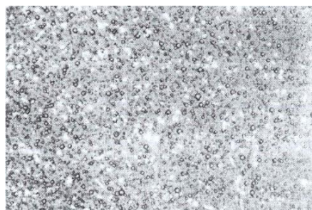
Fig. 6: Mikrografi optike e bashkimit HDPE/PS = 75/25 në 140 °C. Zmadhim 200 x.
