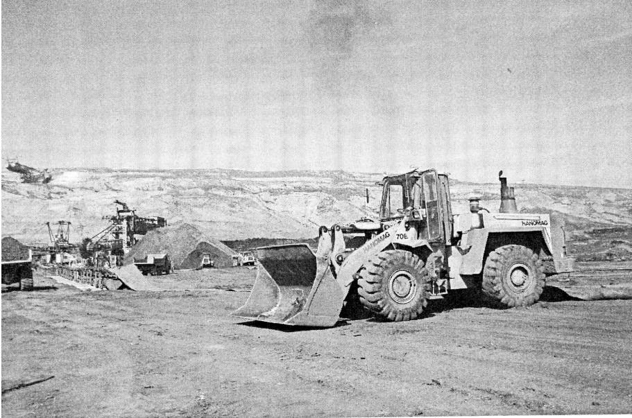
Fig.85) Makina ngarkuese me rrota Fiat Hitachi model W230 në minierën e Sibofcit JP.
