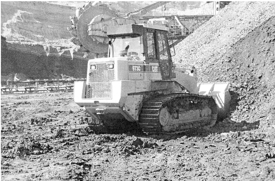
Fig.84) Makina me lopatë ngarkuese me çinguj Catapiler model 973C.
