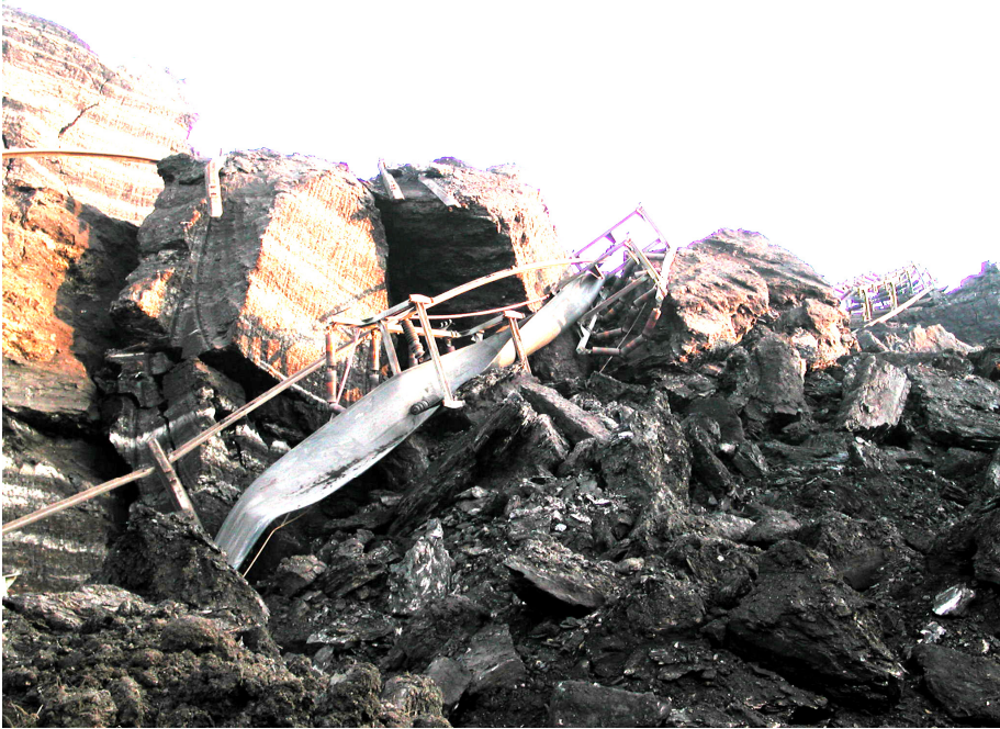
Fig.28. Pamje nga rrëshqitja e frontit të punës në MS të Bardhit në vitin 2002, ku u shkëputën mbi 2 milion m 3 të materialit shterp dhe qymyrit.
