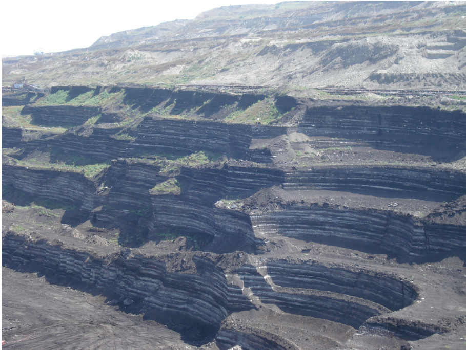
Fig.42.. Formimi i shkallëve të qymyrit me eskavatorë rrotorikë.
