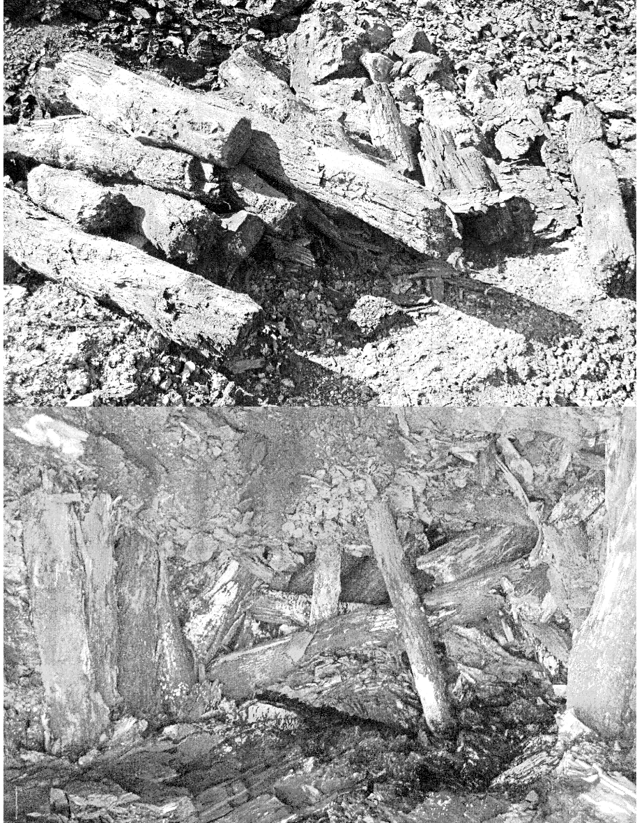
Fig.13. Mbetje të armatesës së drurit nga galeritë e minierave të vjetra nëntokësore që kanë dalë në sipërfaqe nga zhvillimi i punimeve të nxjerrjes së qymyrit me mihje nga sipërfaqja në Mirash dhe në Sibofcin Jugperëndimor.
