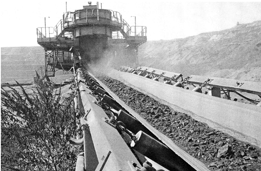
Fig.79) Stacioni ngitës i shkarkim-ngarkimit dhe i tendosjes së shiritit transportues në minierën Sibofci JP.
