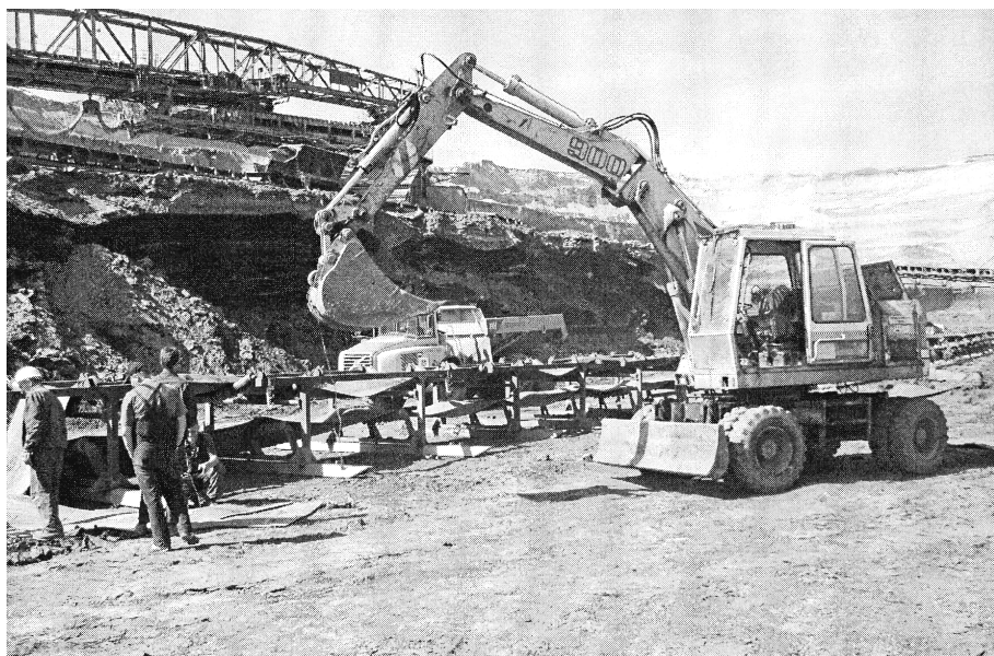
Fi.82) Eskavatori hidraulik me lopatë e çinguj (vimëza) Liberta A900B, që ka shumë përparësi në krahasim me eskavatorët klasikë me lopatë. Pajisjet për ngjitje dhe mbërthimi i tyre është krejtësisht hidraulik.
