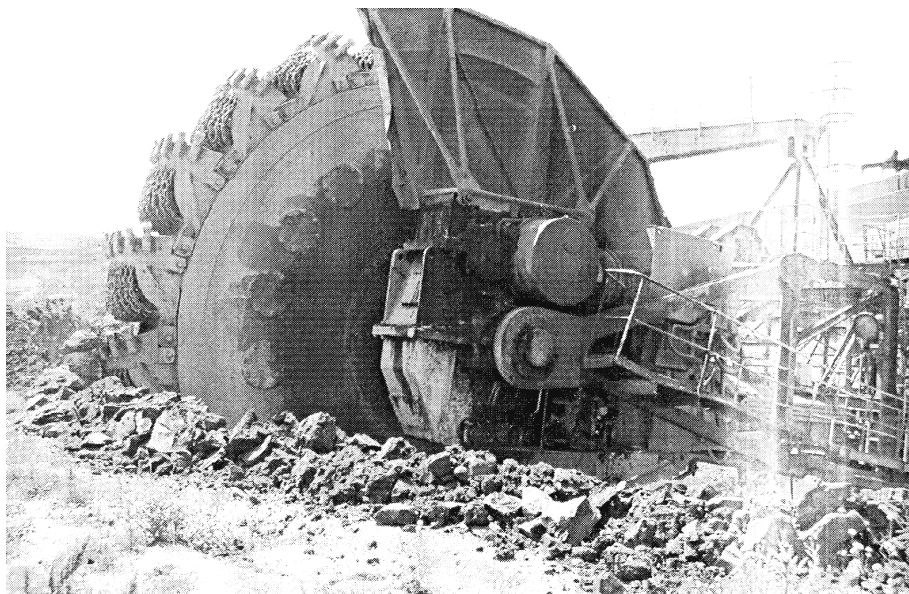
Fig.34. Pamje e rrotës brejtëse të eskavatorit SR 400x14/1,0
