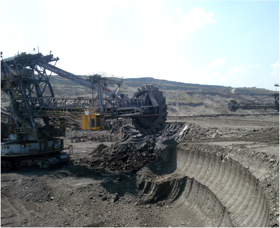
Fig.37. Formimi i shkallëve në materialin shterp të minierës siërfaqësore të Bardhit
