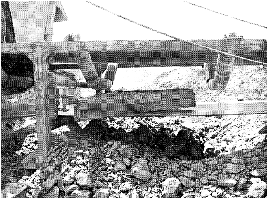
Fig.30. Mekanizmi për pastrimin e shiritit të gomuar në formë V ose gërryesi i shiritit
