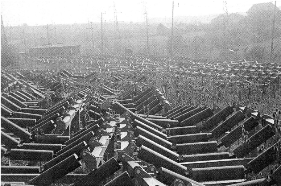
Fig.81) Konstruksioni i ruleve mbajtëse të shiritit transportues në minierën në qiell të hapur të Mirashit.
