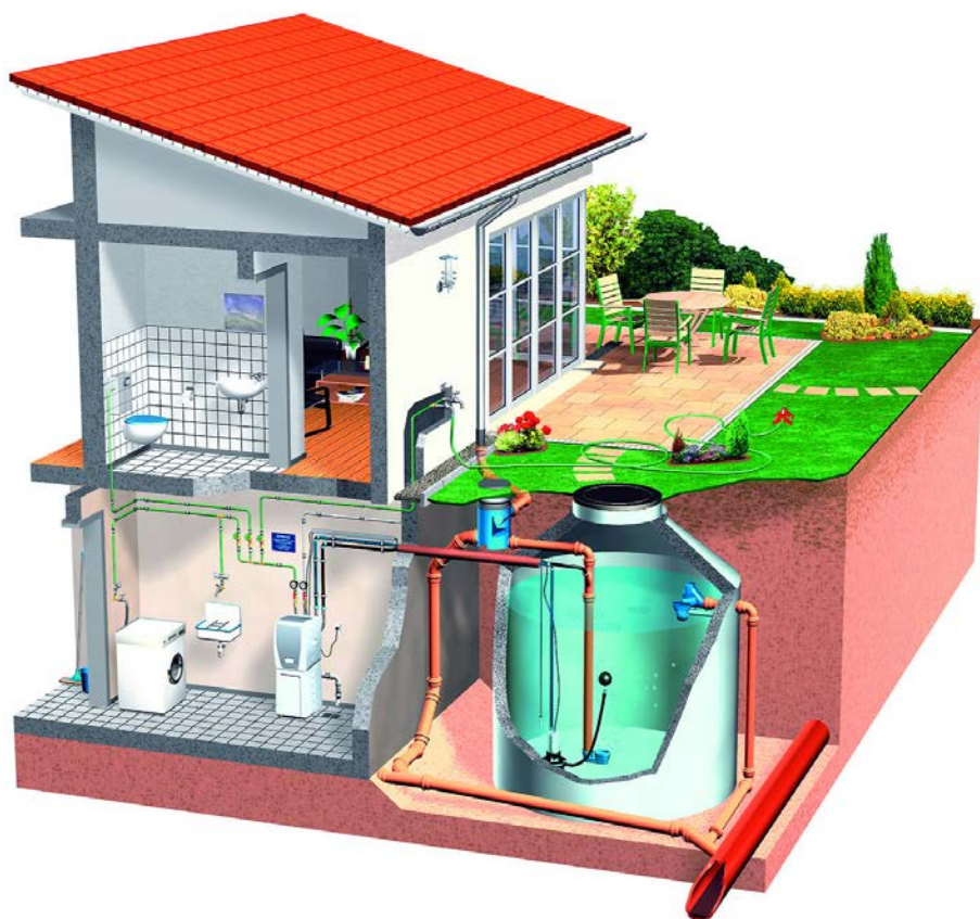
Fig. 14. Pasqyrimi i një sistemi të kompletuar për shfrytëzimin e ujit të shiut për nevoja amvisërie të një shtëpie dhe për ujitjen e kopshtit
